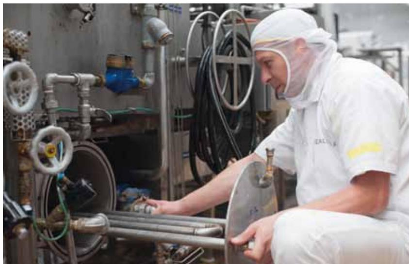
Serpentines de calentamiento en tanque de desmoldeo. Planta Meals, Bogotá, Colombia.
